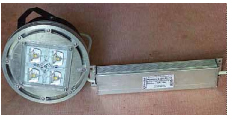
Рис. 12. Экспериментальный образец 100-Вт прожектора с активным охлаждением и внешним блоком питания. Вес светильника – 1,9 кг
