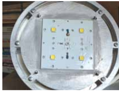
Рис. 5. Плата 2x2-MX со светодиодами XHP70 на радиаторе светильника с активным охлаждением
